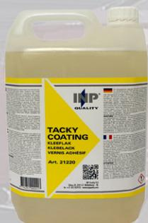
Klebelack. Transparenter, klebriger Staubfanglack auf Wasserbasis für Spritzkabinen, welcher Staub und Lackverschmutzung auffängt und festhält. Die Einsatzdauer hängt von der Belastung in der Kabine ab. Bei "Normaleinsatz" im CarRef-Bereich reicht die einmalige Anwendung pro Jahr. In stärker beanspruchten Kabinen empfiehlt sich ein 2 bis 3 maliger Intervall pro Jahr. Einfach zu verarbeiten
