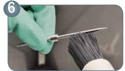
Bei der Reinigung der Düsensatz-Einzelteile ist darauf zu achten, dass die Metallteile der Bürsten den Düsensatz nicht beschädigen. Idealerweise werden Pinsel, speziell hergestellte SATA-Reinigungsbürsten und SATA-Düsenreinigungsnadeln eingesetzt, um eine optimale Pflege und Reinigung des Düsensatzes sicherzustellen.
