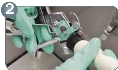
Reinigen des Pistolenkörpers
