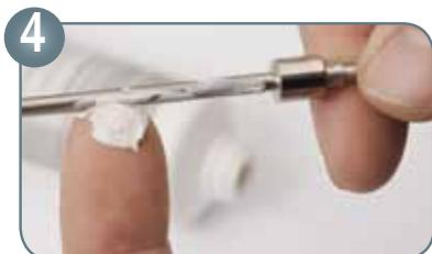
Farbnadel im Bereich der Nadeldichtung einfetten
