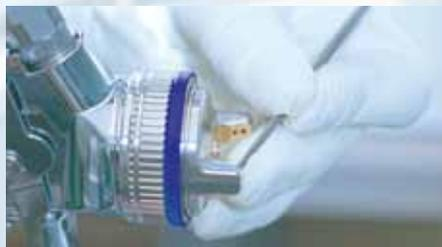
**Handjustierung:** Zur Optimierung des Spritzstrahls wird jeder Düsensatz per Hand „getunt“.
