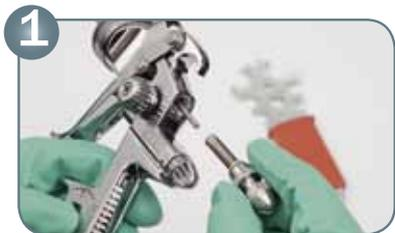
Beim Ausbau des Düsensatzes wird zuerst die Farbnadel herausgenommen.
