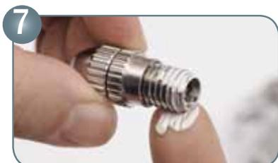
Gewinde der Materialmengenregulierschraube einfetten
