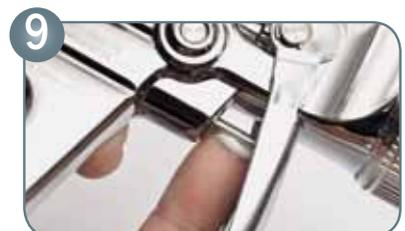
Sichtbarer Bereich der Luftkolbenstange einfetten
