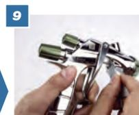
Festziehen der Nadeldichtungs-
