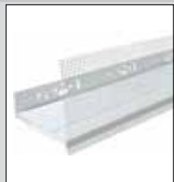
Zweiteilige, weiße, UV-beständige Profile aus Hart-PVC für den Sockelabschluss zur Aufnahme von ProfiTec Therm Dämmplatten. Gegenüber Sockelprofilen aus Aluminium oder Edelstahl wird die Wärmebrückenwirkung minimiert.
