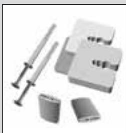
Montage-Set zur Befestigung der Sockelabschlussleiste Aluminium und der PVC-Sockelabschlussleiste mit Gewebe, bestehend aus 75 Nageldübeln 8 x 80 mm, 10 Sockelschienenverbindern und 50 Abstandhaltern je 3 mm.
