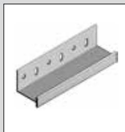
Montageelement zur horizontalen Befestigung von genuteten Mineralwolle-Dämmplatten (M-System 800 x 625 mm) am Untergrund. Eine zusätzliche Verklebung und Verdübelung der Dämmplatten ist erforderlich.
