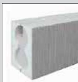
Montageunterlage für wärmebrückenfreie Montage von Hohlraumschalterdosen, 2-fach. In WDV-Systemen mit Dämmstoffen aus EPS, Mineralwolle, Holzweichfaser usw. einsetzbar. Geeignet für alle gängigen Hohlraumschalterdosen mit Durchmesser von 68 mm.
