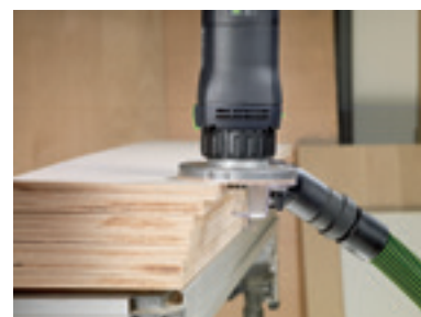
Fasefräsen von Kunststoff- oder Massivholzumleimern.
