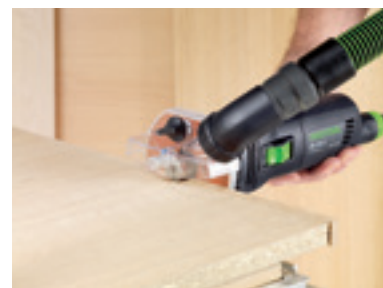
Bündigfräsen von Kunststoff- oder Massivholzumleimern.
