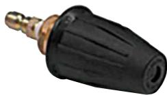
Rotierende und oszillierende Düsen erhöhen die Reinigungsleistung und senken den Reinigungsaufwand. Mit 0° Strahleinwirkung erreichen sie eine Abdeckung von 25°. Die Düsen sind mit Filter und Schnellkupplung ausgestattet und bestehen aus langlebigen und zuverlässigen Hochleistungskomponenten. Für Bürgersteige, Auffahrten, Straßenbeläge, schlammige Bereiche, abblätternde Farben und Betonflächen
