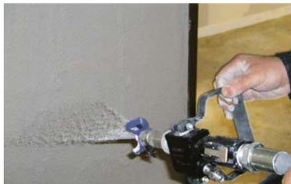
Die T-Max™ ist speziell für das Auftragen Von Spachtelmassen und gefüllten Materialien ausgerichtet. In Verbindung mit einem externen Kompressor können mit der T-Max™ auch dekorative gekörnte Materialien bis 1,5mm Korn gespritzt werden. Die T-Max™ wurde für das Auftragen der anspruchsvollsten Spachtelmassen (Fertigware oder vorgemischte Sackware) getestet, die derzeit auf dem Markt angeboten werden, und ist für diesen Einsatz zugelassen.
