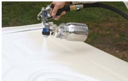
Graco HVLP TurboForce™ -Turbinen sind für den täglichen Einsatz geeignet. Sie wurden speziell für Anwender entwickelt, die vor Ort Türen, Dekorelemente, Geländer, Zäune usw. lackieren. Mit ihnen sind exakte und kontrollierte Fine-Finish-Anwendungen möglich. Für ein einwandfreies Aufbringen von Farben, Lacken (Acryl-Alkyd-oder Epoxiharz), Lasuren und Multicolorbeschichtungen.
