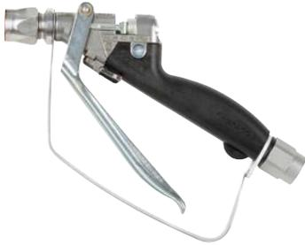
Diese Airless-Pistole ist für einen hohen Durchlass von zähflüssigen Materialien optimiert und verfügt über einen 1/2" Materialdurchlass. Größere Freiheit beim Arbeiten dank einer Krümmung von nur 30° an der Pistolenspitze. "Form-fit"- Kunststoffgriff für perfekte Griffbarkeit.
