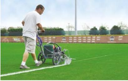
Mit dem FieldLazer™ ermöglicht Graco das Airless-Spritzen auf dem Spielfeld. Im Unterschied zu Förderpumpen, die die Farbe zerstäuben, wird die Farbe beim Airless-Prinzip atomisiert. So erhält man bereits in einem Durchgang gleichmäßige, helle Linien. Mit nur 36 kg ist der FieldLazer eines der derzeit leichtesten Spritzgeräte für Sportanlagen. Dies erhöht die Manövrierfähigkeit für Ecken und Kreise und ermöglicht ermüdungsfreies Arbeiten.
