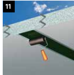
11 Anpressen der Lamellen mit dem Sika Gummiroller
