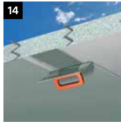
14 Mit zementösem Flächenspachtel (z.B. Sika MonoTop-723 N) beschichtete Sika CarboDur CFK-Lamelle mit einem Anstrich versehen (z.B. Sikagard-550 W Elastic)
