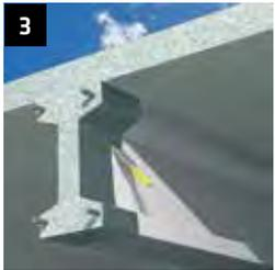
**3** Reprofilieren mit Sikadur®-41 CF Normal bzw. Sikadur®-30 Normal mit Quarzsand (max. 1 : 1 Gewichtsteile)
