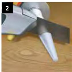
**2** Düse so zuschneiden, dass ein Dreieck mit einer Seitenlänge von ca. 5 mm ausgepresst werden kann
