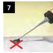
**7** Bei jeder neuen Kartusche oder nach dem Auswechseln des Statikmischers dürfen die ersten Hübe (ca. 2 Hübe) nicht verwendet werden, bis eine einheitliche Mischkonsistenz erreicht ist.
