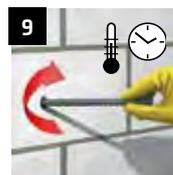
**9** Anker mit Drehbewegung in das verfüllte Bohrloch einführen. Klebstoff muss am Bohrlochende austreten.
