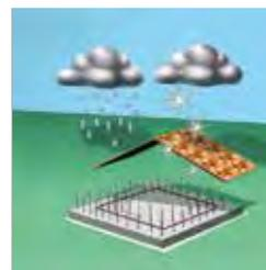
Vor dem Einbetonieren nicht mit (Regen-)Wasser in Kontakt kommen lassen, max. 1 Tag zulässig, solange das Wasser abfließen kann
