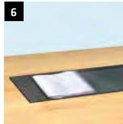
**6** Reinigen der Sika® CarboDur® CFK-Lamellen mit einem weißen Lappen und Colma-Reiniger. Schutzhandschuhe und -brille tragen! Mind. 10 Minuten ablüften lassen!
