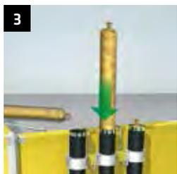
3 Die drei Zylinder mit SikaBond®-52 Parquet 1.800 ml Portionen füllen. (Bei Nachfüllung: ausgepresste Alupartionen entfernen).
