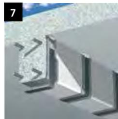
**7** Einschieben des präparierten Winkelendes in die gefüllte Verankerungsbohrung/-schlitz
