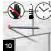
**10** Während der Aushärtungszeit darf der Anker in keinem Fall bewegt oder belastet werden.
