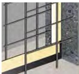
Anschluss vertikale - horizontale Arbeitsfuge
