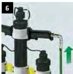
6 Luftschlauch anschließen (Arbeitsdruck 6 - 8 bar) und Klebstoff durch Ziehen des Dispensers auftragen. Klebstoffmenge durch Luftdruck und/oder Laufgeschwindigkeit regulieren.
