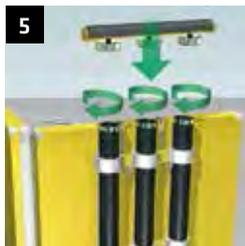
5 Dispenserkopf aufsetzen und die drei Überwurfmutter aufschrauben und gut anziehen.
