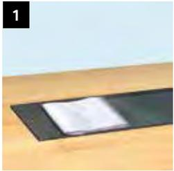
Anschleifen der Lamellenenden auf der nicht geschliffenen Seiten auf ca. 10 cm Länge
