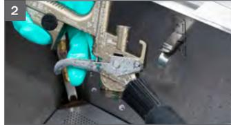
2 Reinigen des Pistolenkörpers
