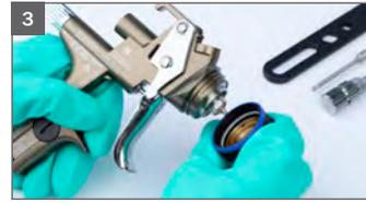
3 Zum Schluss wird mit dem im Universal-Werkzeug integrierten Ringschlüssel die Farbdüse ausgeschraubt.
