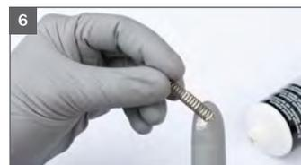
6 Farbnadelfeder einfetten und einsetzen
