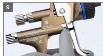
9 Sichtbarer Bereich der Luftkolbenstange einfetten
