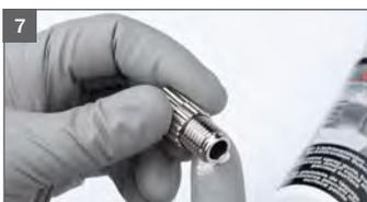
7 Gewinde der Materialmengenregulierschraube einfetten
