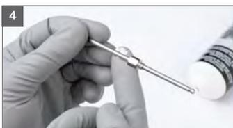
4 Farbnadel im Bereich der Nadeldichtung einfetten
