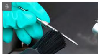
Bei der Reinigung der Düsenatz-Einzelteile ist darauf zu achten, dass die Metallteile der Bürsten den Düsenatz nicht beschädigen. Idealerweise werden Pinsel, speziell hergestellte SATA-Reinigungsbürsten und SATA-Düsenreinigungsnadeln eingesetzt, um eine optimale Pflege und Reinigung des Düsenatzes sicherzustellen.
