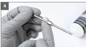
4 Farbnadel im Bereich der Nadeldichtung einfetten
