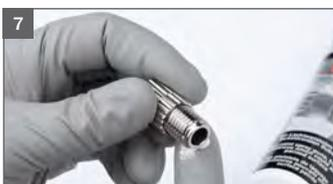
7 Gewinde der Materialmengenregulierschraube einfetten
