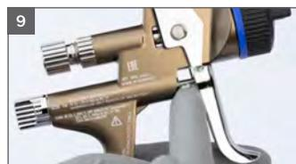
9 Sichtbarer Bereich der Luftkolbenstange einfetten
