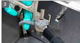
2 Reinigen des Pistolenkörpers
