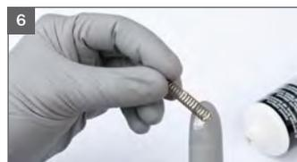
6 Farbnadelfeder einfetten und einsetzen
