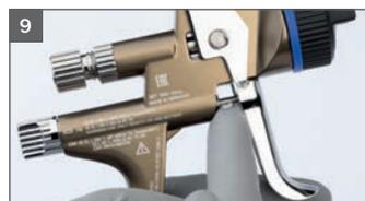
9 Sichtbarer Bereich der Luftkolbenstange einfetten
