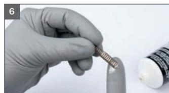
6 Farbnadelfeder einfetten und einsetzen
