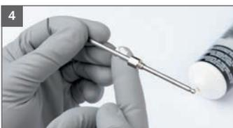
4 Farbnadel im Bereich der Nadeldichtung einfetten
