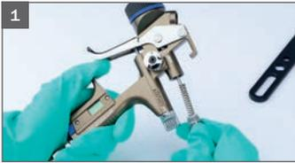
1 Beim Ausbau des Düsensatzes wird zuerst die Farbnadel herausgenommen.
