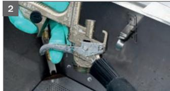
2 Reinigen des Pistolenkörpers
