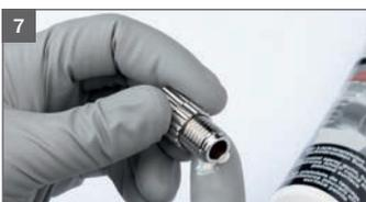
7 Gewinde der Materialmengenregulierschraube einfetten
