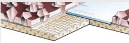
Gestossene Verbindung mit kornseitiger Spezialfolie
