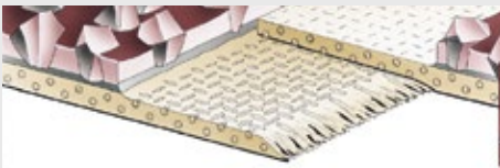
Überlappende Verbindung mit Kornabschliff
