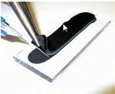
Bild 4: Die ersten 10 - 20 mm der Raupe lösen
